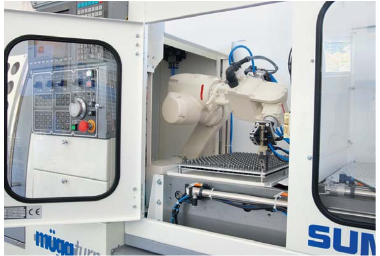
Integriert in das Anlagensystem ist der bewährte MOTOMAN-HP3L in dichter Ausführung.
