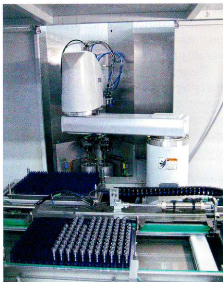
Der Sumo Ecoplex 3 ist eine kompakte Einheit mit den Maßen 2,2 x 1,1 x 2 m, der mit unterschiedlichen Robotertypen ausgerüstet werden kann
