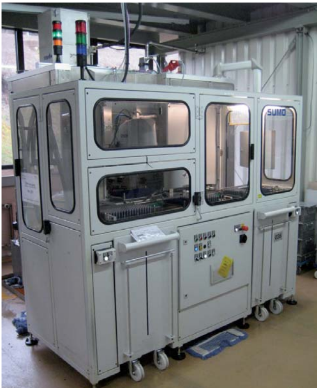
Der Ecoplex3 ist eine kompakte Palettierzelle, kann mit unterschiedlichen Knickarm- und Scara-Robotern ausgerüstet werden und verarbeitet obendrein unterschiedliche Palettenformate sowie Behälter.
