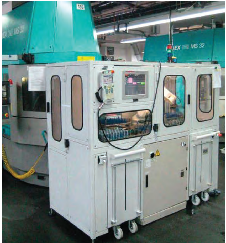
1 Automatisierung eines Mehrspindel-Drehautomaten: Das System Sumo Ecoplex3 führt die Teile der Maschine zu und legt sie nach der Bearbeitung auf einer Palette ab
