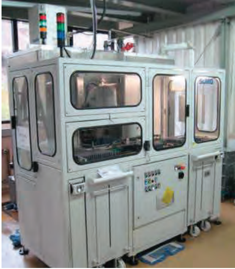
3 Zur Werkstückzufuhr und -abfuhr kommen Palettenwagen zur Aufnahme der kundeneigenen Paletten zum Einsatz. Bei kurzen Taktzeiten wird ein Scara-Roboter verwendet
