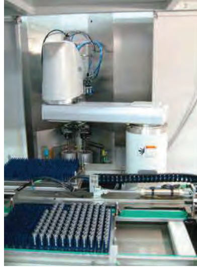
3 Zur Werkstückzufuhr und -abfuhr kommen Palettenwagen zur Aufnahme der kundeneigenen Paletten zum Einsatz. Bei kurzen Taktzeiten wird ein Scara-Roboter verwendet
