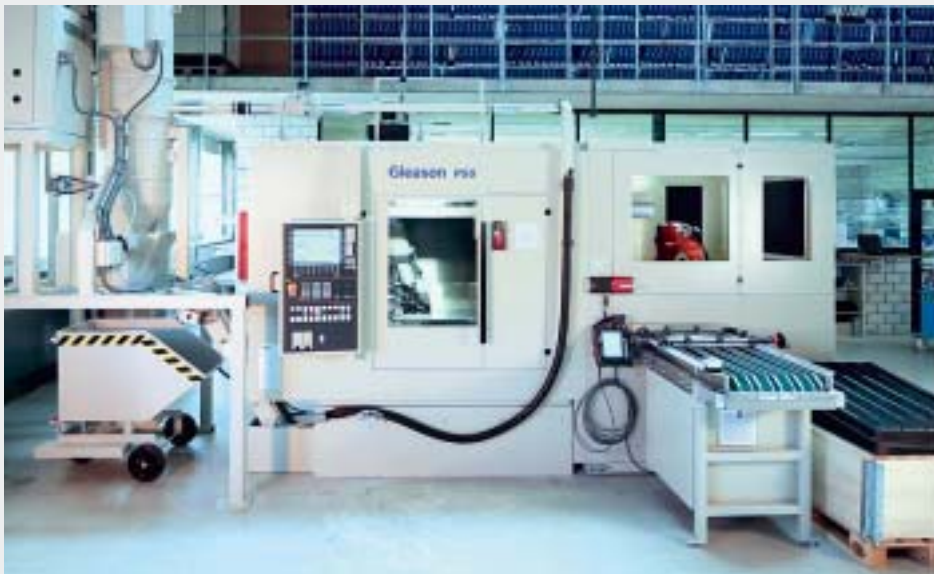
Bedienerseite der Gesamtanlage. Die Maschinentüre ist für Rüstvorgänge voll zugänglich, die automatische Beladung erfolgt seitlich an der Maschine
