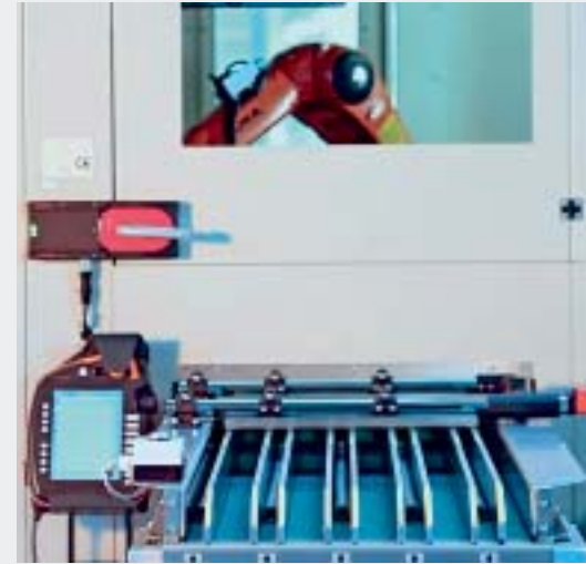
Mittels zentraler Breitenverstellung können die Bahnen des Zuführsystems auf die unterschiedlichen Werkstückdurchmesser angepasst werden
