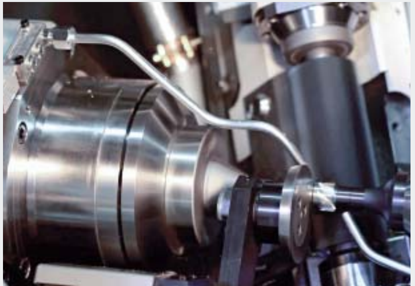
Kombinierter Verzahnungs- und Primärentgratprozess in der Wälzfräsmaschine Gleason P90
