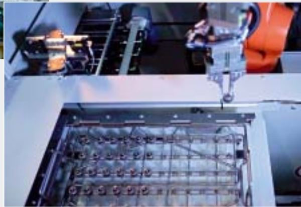
Kombinierter Verzahnungs- und Primärentgratprozess in der Wälzfräsmaschine Gleason P90
