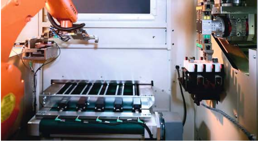
4 Flexible Werkstückzuführung, Werkstückprüfung und Übergabeposition an den Maschinenlader. Der Werkstücktransport erfolgt durch den Kuka KR6 R900 sixx
