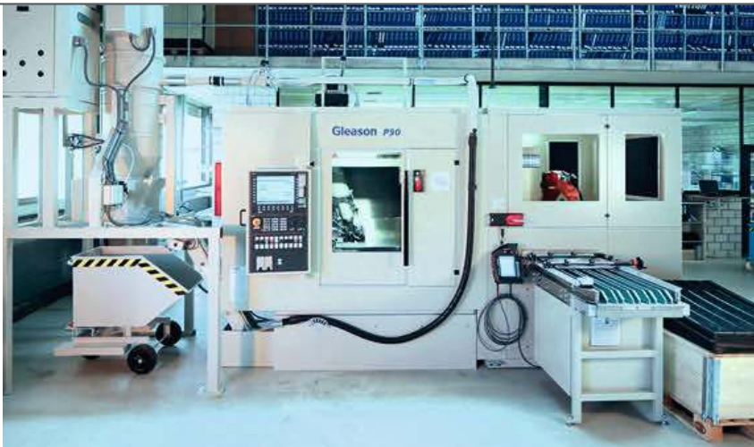
2 Bedienerseite der Gesamtanlage. Die Maschinentüre ist für Rüstvorgänge voll zugänglich, die automatische Beladung erfolgt seitlich der Maschine
