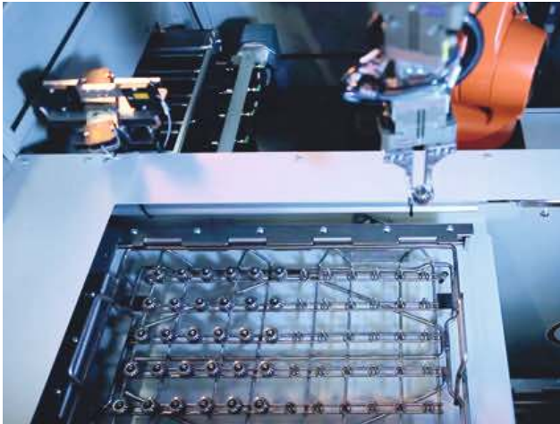
6 Die bearbeiteten Werkstücke werden vom Roboter in die kundeneigenen Werkstückträger eingesetzt
