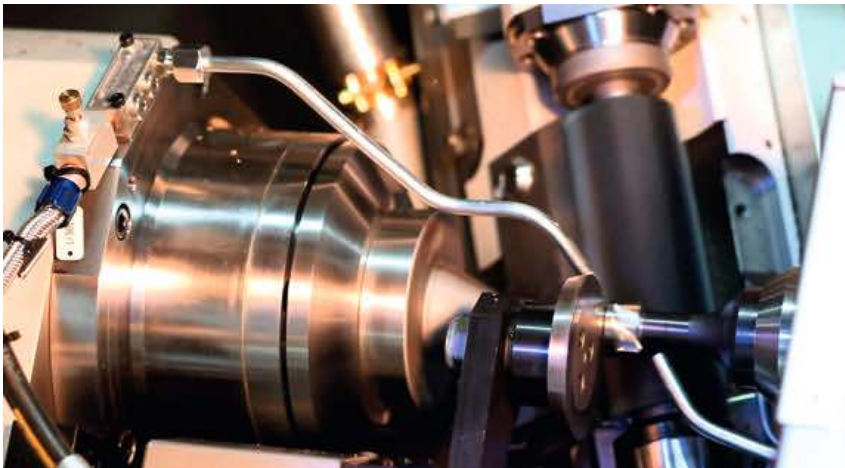
5 Kombiniertes Verzahnungs- und Primärentgratprozess in der Wälzfräsmaschine Gleason P 90
