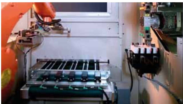
Bild 4: Flexible Werkstückzuführung, Werkstückprüfung und Übergabeposition an den Maschinenlader. Der Werkstücktransport erfolgt durch den Kuka KR6 R900 sixx
