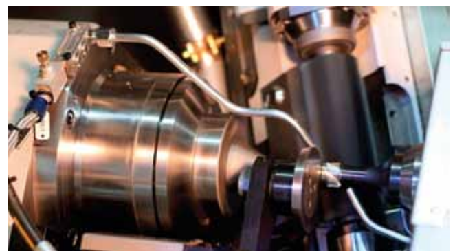
Bild 5: Kombiniertes Verzahnungs- und Primärentgratprozess in der Wälzfräsmaschine Gleason P90 (Werkbilder: EGS Automatisierungstechnik GmbH, Donaueschingen)
