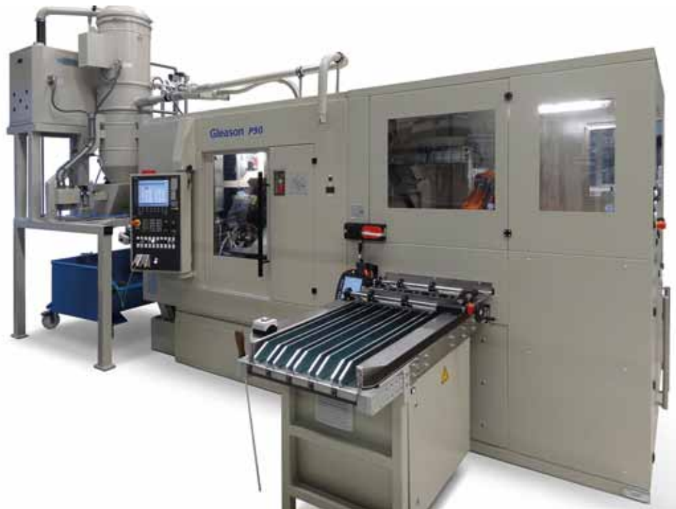
Bild 1: Gesamtanlage Wälzfräsmaschine Gleason P90 und EGS Roboter- automation, eine kompakte und funktionelle Einheit mit hoher Ausbringung
