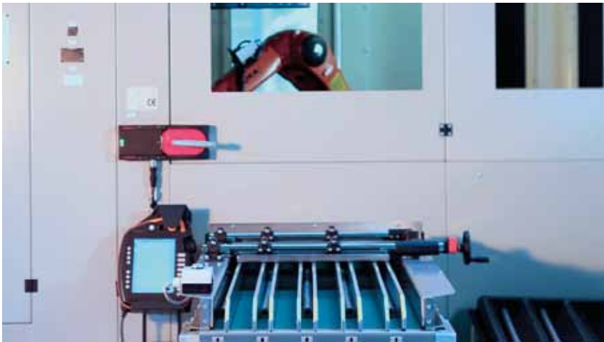
Bild 3: Mittels zentraler Breitenverstellung können die Bahnen des Zuführsystems auf die unterschiedlichen Werkstückdurchmesser angepasst werden
