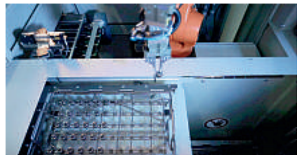
Die bearbeiteten Werkstücke werden vom Roboter in die kundeneigenen Werkstückträger eingesetzt.
