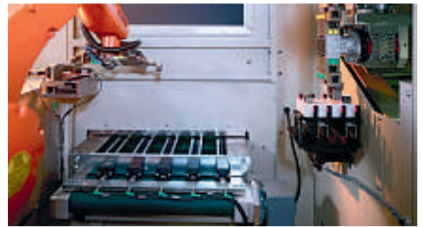
Den Werkstücktransport übernimmt der Kuka KR6 R900 sixx. Zentrale Breitenverstellung der Zuführbahnen ermöglicht deren Anpassung an unterschiedliche Werkstückdurchmesser.
