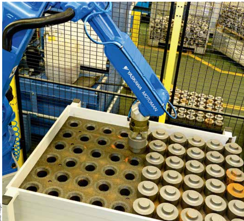
Bild 1: Der Roboter HP20D übernimmt einen Rohling aus der Palette und übergibt ihn an das Drehzentrum.
