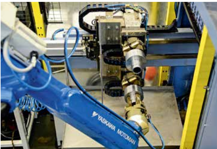
Bild 3: Nach der Drehbearbeitung holt ein zweiter Roboter die Teile ab und führt weitere Bearbeitungsschritte aus.
