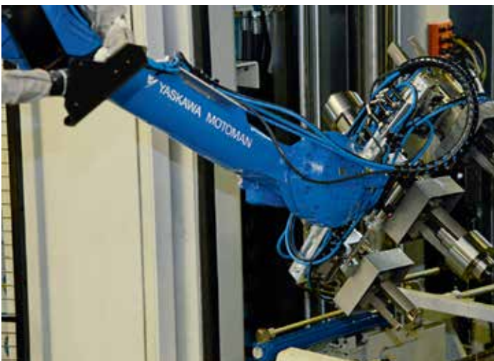
Bild 4: Das Be- und Entladen der Räummaschine erledigt ein großer Sechsscher vom Typ MH50 mit einem Doppel-Dreifach-Greifer.
