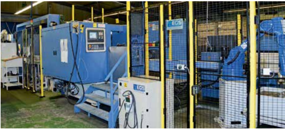
Bild 2: Blick auf das Automatisierungsmodul eins mit dem angeschlossenen Drehzentrum.
