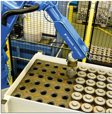
Bild 1: Der Roboter HP20D übernimmt einen Rohling aus der Palette und übergibt ihn an das Drehzentrum. (Bild: Högel)
