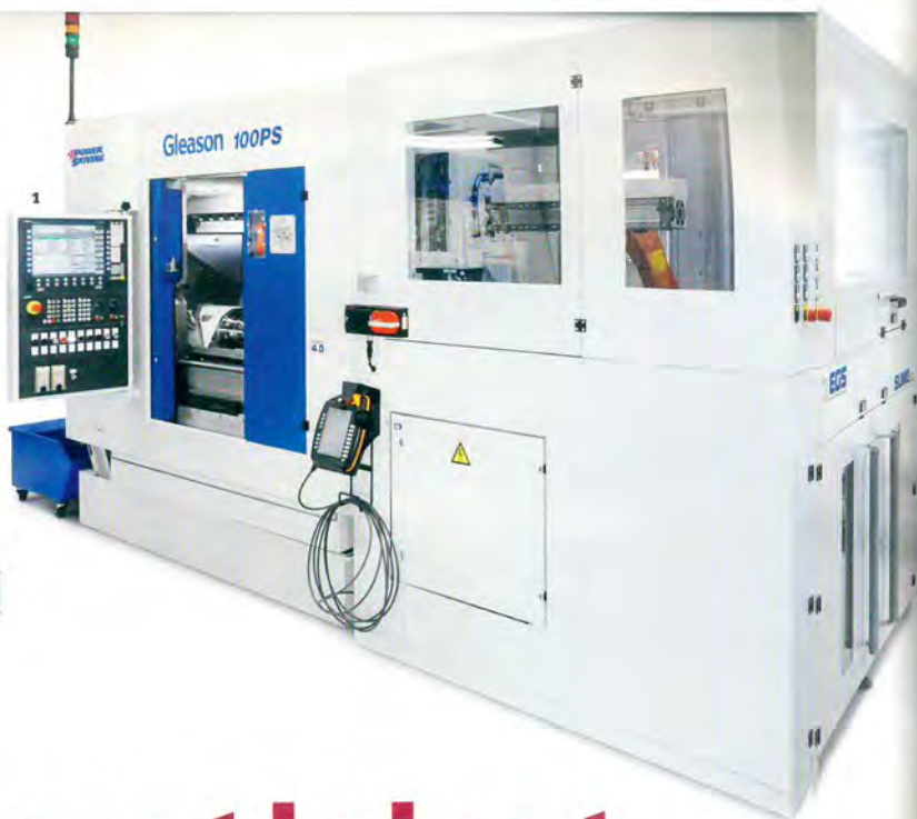
1 Die Gleason-100PS-Wälzschälmaschine und die EGS-Automationszelle bilden sowohl funktionell als auch optisch eine Einheit. 2 Anwendungsbeispiel Power Skiving: Hohlrad eines Planetengetriebes.
