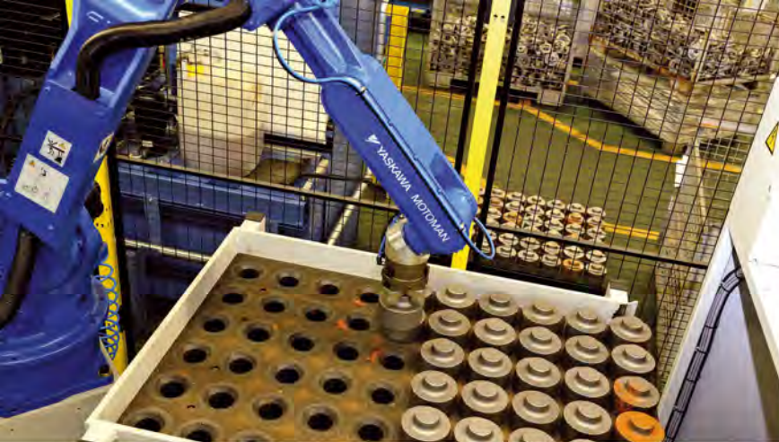
Ein MOTOMAN HP20D übernimmt einen Rohling aus der Palette und übergibt ihn an das Drehzentrum.
