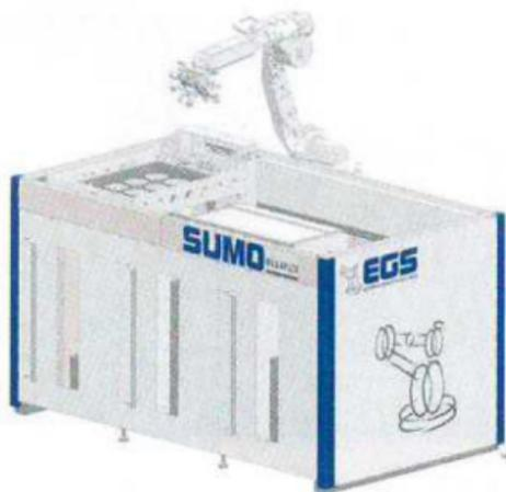
Werkstückträger. Durch die wechselnde Abarbeitung der drei Stapel kann jederzeit auf einen Wagen zum Tausch zugegriffen werden, die Autonomie des Systems beträgt zwei Türme. Die Palettierung ist mit frei programmierbaren Servoachsen realisiert, sodass Werkstückträger unterschiedlicher Höhe verarbeitet werden können. Am Motek-Stand wird der Megaplex mit dem neuen Yaskawa MH24 ausgerüstet sein.
