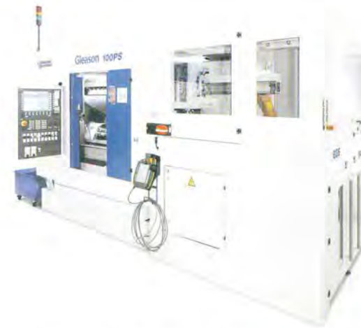
2 Optisch und funktionell zur Einheit verschmolzen: Gleason-Wälzschälmaschine 100PS mit adaptierter EGS-Automationszelle
