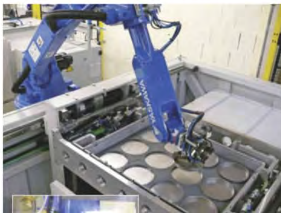
Werkstücke werden in Werkstückträgern im Format 800 x 600 mm bevorratet
