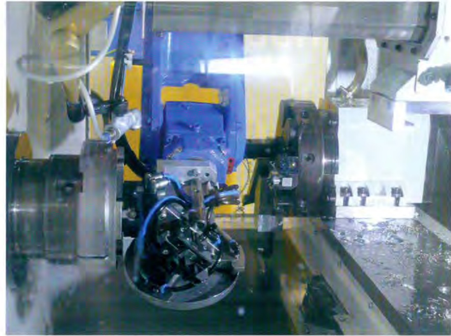
Bild 1: Spezial-Mehrfach-Greiferwerkzeug zum Einlegen und Entnehmen unter schwierigen Platzverhältnissen im Arbeitsraum der Maschine
