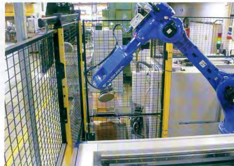
Bild 3. Die Ausgabe von Werkstücken oder „Nicht in Ordnung“-Teilen geschieht über eine separate Rutsche.
