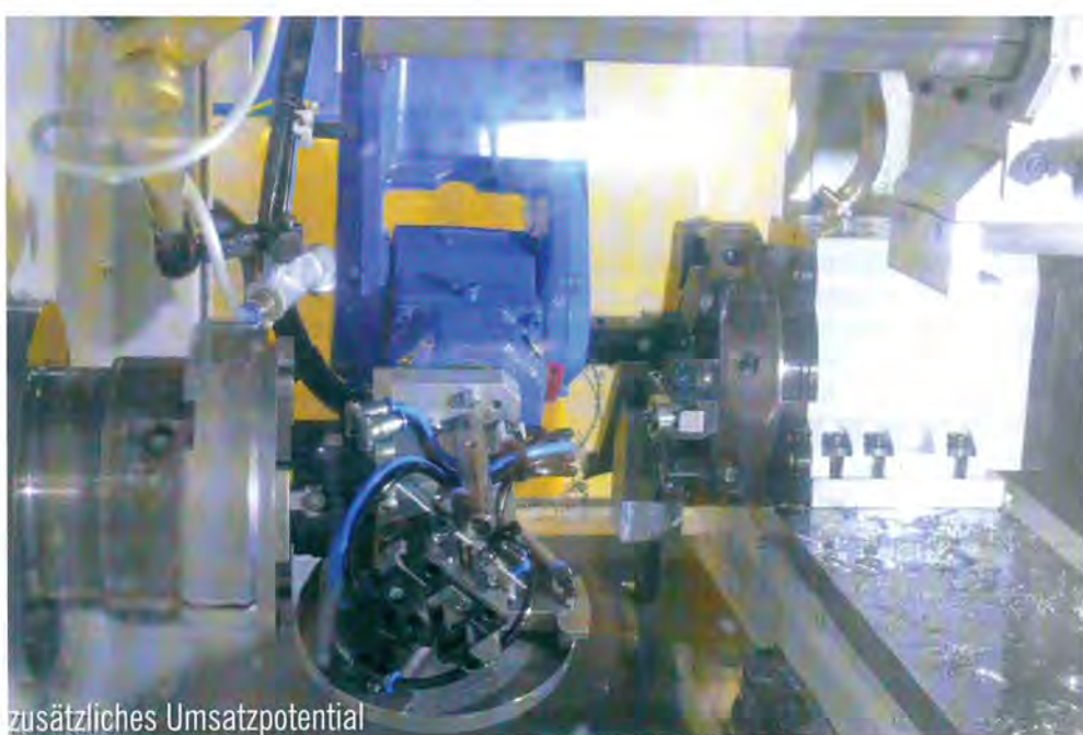
Bild 1. Spezial-Mehrfach-Greiferwerkzeug zum Einlegen und Entnehmen unter schwierigen Platzverhältnissen im Arbeitsraum der Maschine.
