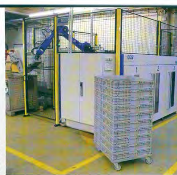
Bild 2. Werkstückträgerstapel bis zu einer Höhe von 1,1 m können in die drei Palettenplätze des „Sumo Megaplex“ eingebracht werden.
