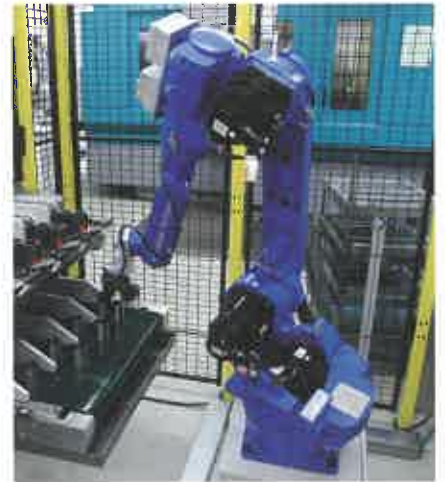
Rechts: Unbearbeitete Teile holt sich der Sechssacher von den vier oberliegenden Zufuhrbändern. Fertigteile legt er auf den Ausschleusbändern ab.
