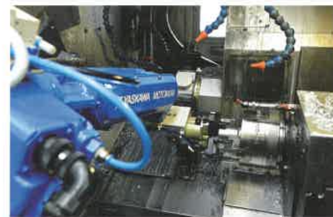
Für das Be- und Entladen muss sich der »Motoman MH6« weit in den Arbeitsraum des Bearbeitungszentrums strecken.
