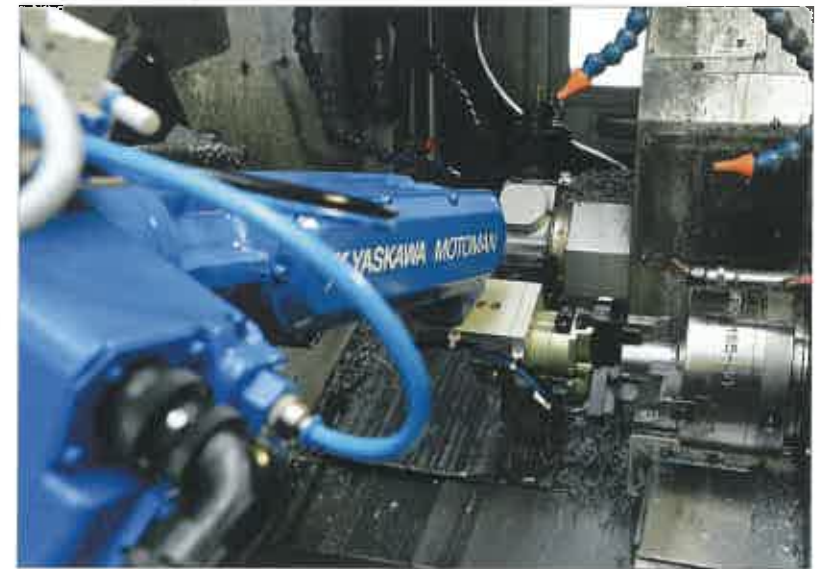
Für das Be- und Entladen muss sich der Motoman MH6 weit in den Arbeitsraum des Bearbeitungszentrums strecken.
