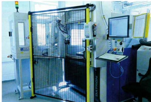
Bild 2. Die seitlich an die Maschine angeordnete EGS-Automation benötigt nur wenig Platz.
