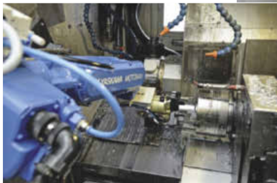
Für das Be- und Entladen muss sich der Motoman MH6 weit in den Arbeitsraum des Bearbeitungszentrums strecken.
