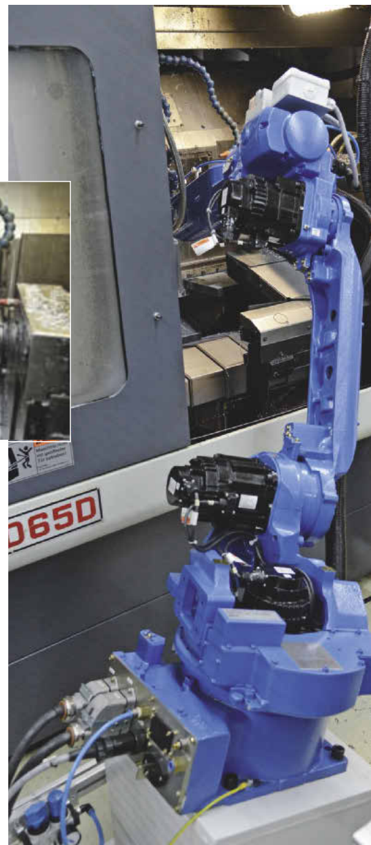
Der MH6 Roboter greift sich ein unbearbeitetes Teil vom Zuführband und legt es präzise in die Hauptspindel der Drehmaschine ein. Bilder: Ralf Högel
