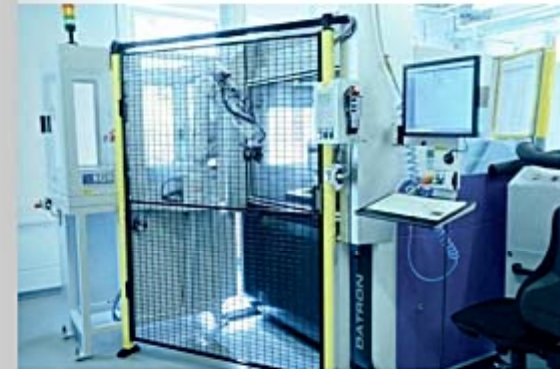
Der Epson Roboter bei der Teileausschleusung für die statistische Prozesskontrolle.
