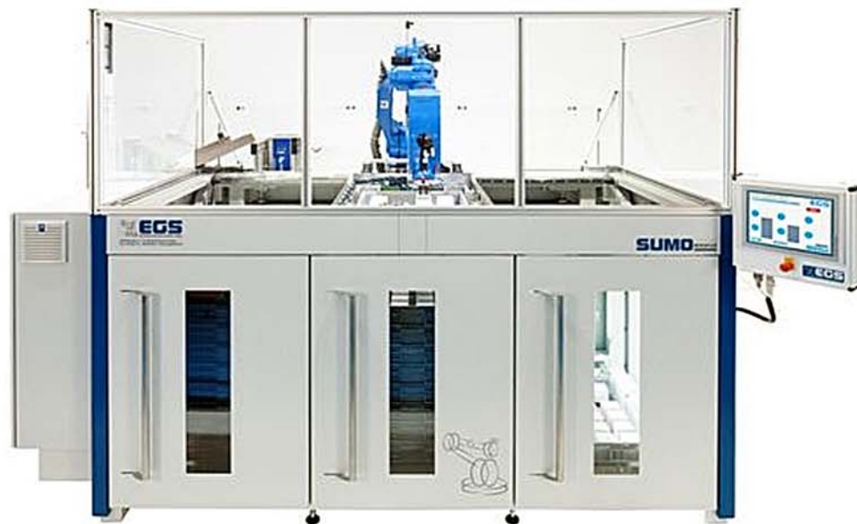
Der Sumo Megaplex ist ein Palettiersystem mit großer Werkstückautonomie (© EGS Automatisierungstechnik GmbH)
