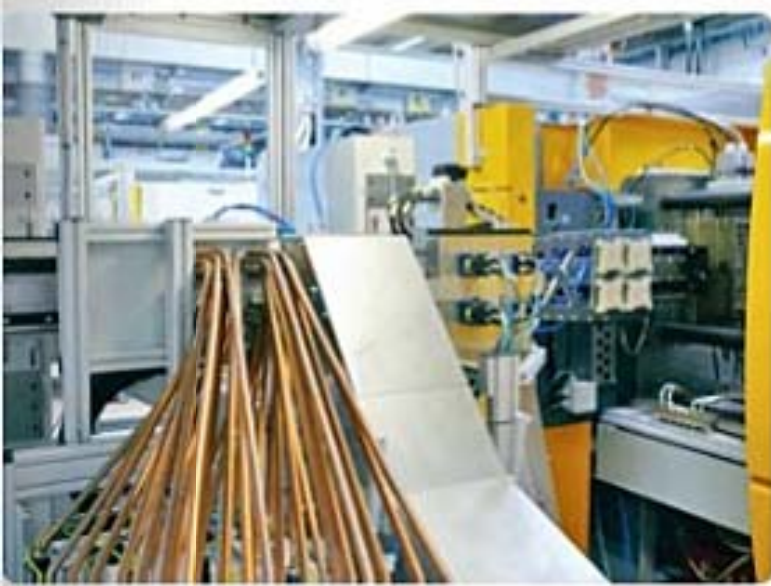
Nach der Entnahme werden die Teile über eine Rohrkulisse nach Werkzeugnestern getrennt separiert.
