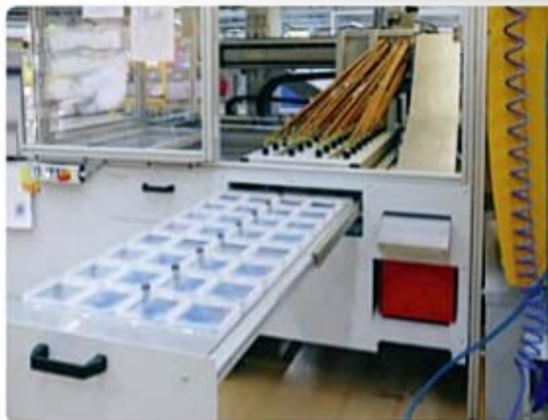
Eine der beiden Fertigteilshubladen ist zur Entnahme der Fertigteile ausgezogen.
