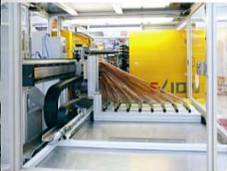
Das Highspeed-Entnahmehandling wechselt zwischen der Entnahmeposition in der Maschine, Highspeed-Kamerakontrolle und Abgabeposition an der Rohrkulisse hin und her.
