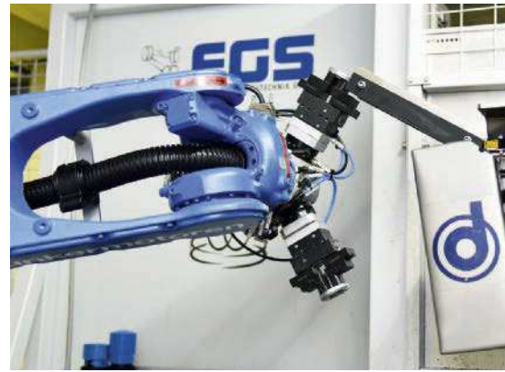
Der Roboter bei der Übergabe der Lagerschilde an das Zuführsystem.
