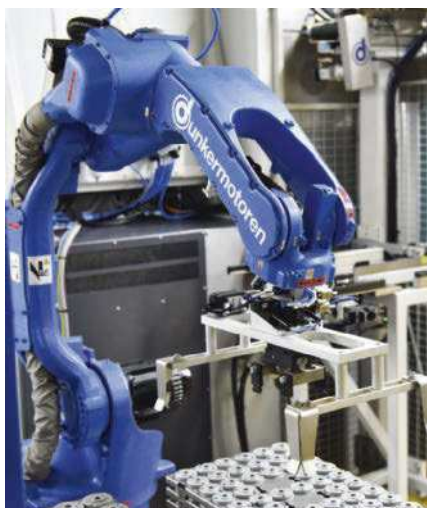
Der Sechssachser beim Abholen eines Werkstückträgers vom ersten von insgesamt fünf Palettenstapeln.
