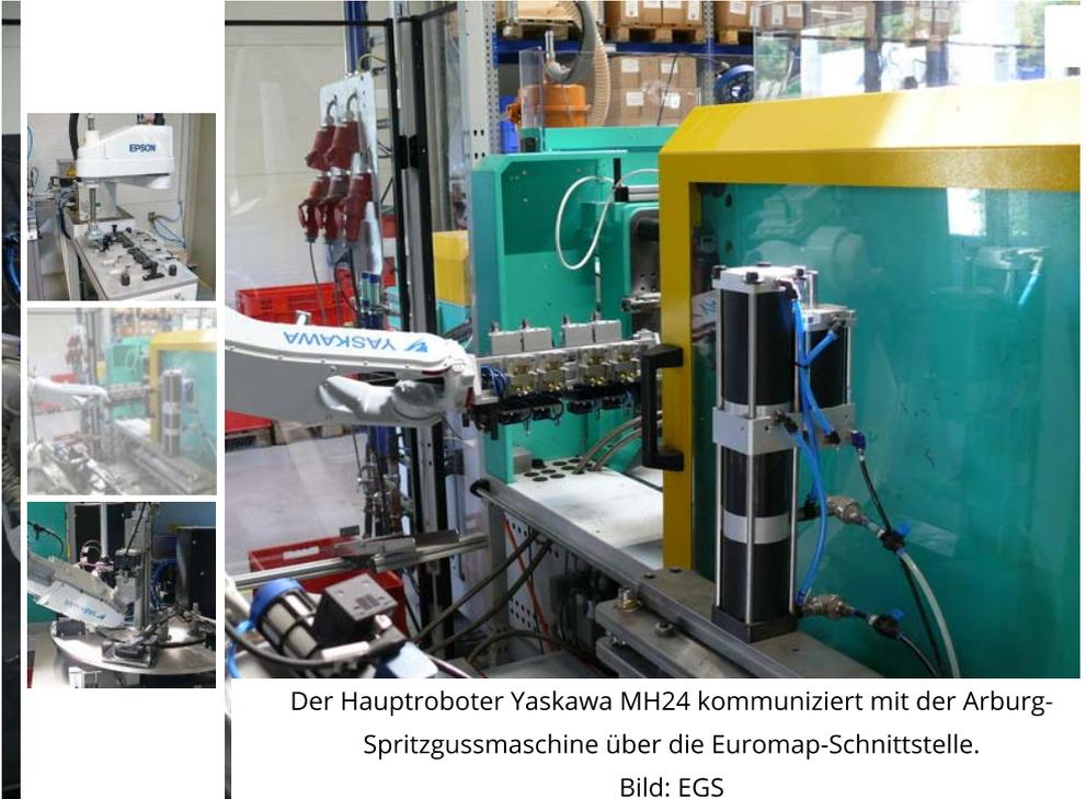
Der Hauptroboter Yaskawa MH24 kommuniziert mit der Arburg-Spritzgussmaschine über die Euromap-Schnittstelle.
