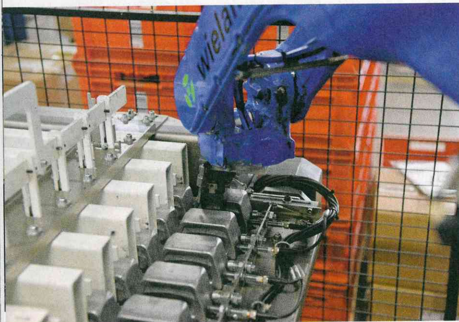
Wieland Electric setzt bei der automatisierten Zuführung auf einen Handlingroboter Motoman MH12 von Yaskawa. (Bild: Ralf Högel)
