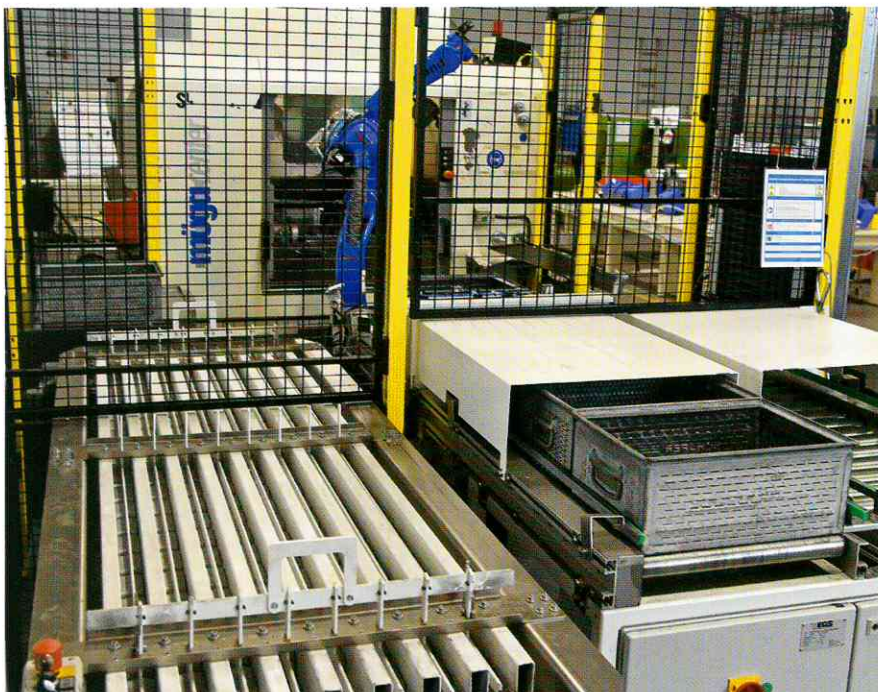
Die Anlage im Überblick: links die achtspurige Zuführung, rechts die leeren Metallbehälter für die Fertigteile, im Hintergrund Roboter und Werkzeugmaschine.
