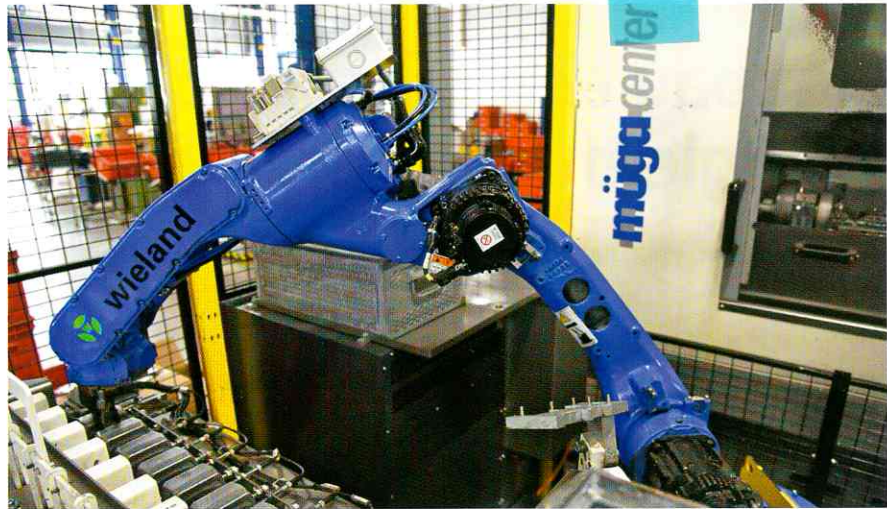
Der Sechssacher holt ein Gehäuseeteil an der Zuführung ab ...
