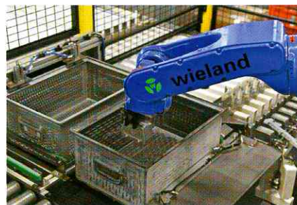
Fertig bearbeitete Teile lässt der Roboter in einen bereit- stehenden Metallbehälter fallen.
