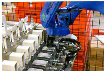
Der Roboter greift ein Teil ab und legt es in die Spannvorrichtung.
