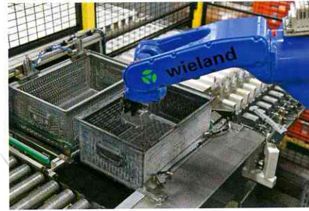
Der Roboter führt die Rohteile zu und entnimmt während der Bearbeitung fertige Teile.
