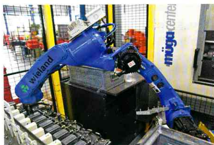
Bei der automatisierten Zuführung setzt Wieland Electric auf einen Handlingroboter.
