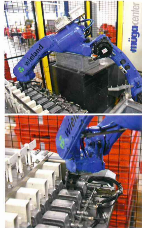
Wieland Electric setzt bei der Steckerproduktion auf eine automatisierte Zuführung per Handling-Roboter von Yaskawa.
