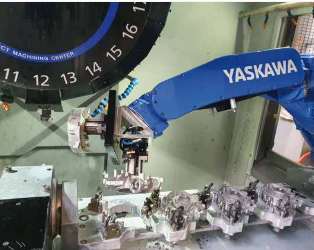
Der Roboter fährt über spezielle Automationstüren in die beiden Maschinen ein, so dass sie für die Bediener über die Fronttüren für Rüstvorgänge voll zugänglich sind.
