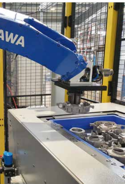
Die Werkstückträger bevorraten acht Bauteile mittels werkstückspezifischer Aufnahmen und stellen sie sicher positioniert bereit.
