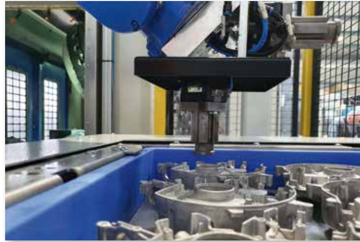
Ein Endeffektor mit werkstückspezifischen Greiferbacken gewährleistet einen sicheren Halt der Bauteile auch unter widrigen Umgebungsbedingungen, im Kühlschmiermittelnebel und ständigen Kontakt mit Spänen.
