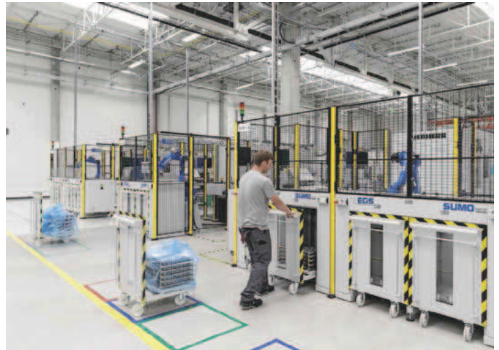
Flexibles Logistikkonzept: Vorbereitete Wagen mit Werkstückträgern stehen vor den Palettiersystemen zum Wechsel bereit.
